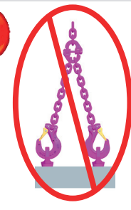
Abbildung 2: Falsche Montage und Anwendung Nur 1 tragender Strang zulässig.
