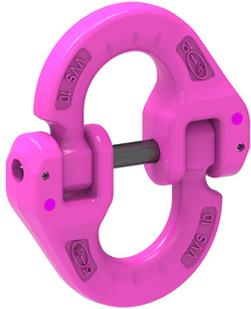
Das universell einsetzbare, zum Patent angemeldete VIP-Verbindungsschloß. Kein Verklanken der montierten Kette möglich. Der Verbindungsstift wird durch die bewährte Spannhülsen-Sicherung gehalten. Kein Wandern bzw. Beschädigen des Verbindungsstiftes. In die Schloßbügelhälften können Fremdanschlüsse z.B. Anschlagpunkte, Blechgreifer etc. sowie die Kette montiert werden.
