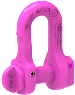
Hochfeste Ausführung mit integriertem Sicherungsgewinde im Schäkelbügel. Beidseitig glatte Bolzenauflage im Schäkel. Bolzen drehbar. Keine Biegespannung im Gewinde, sondern nur Sicherungsfunktion. Langzeitsicherung durch Einschlagen der vormontierten Spannhülse. Sondergewinde, dadurch verwechslungsfrei gegenüber anderen Schäkelbolzen!
