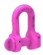
Hochfeste Ausführung mit integriertem Sicherungsgewinde im Schäkelbügel. Beidseitig glatte Bolzenauflage im Schäkel. Bolzen drehbar. Keine Biegespannung im Gewinde, sondern nur Sicherungsfunktion. Langzeitsicherung durch Einschlagen der vormontierten Spannhülse. Sondergewinde, dadurch verwechslungfrei gegenüber anderen Schäkelbolzen!
