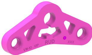
VIP-Wippen werden in 4-Strang-Gehänge (2x2-Strang eingebaut, um eine gleichmäßige Lastverteilung auf alle 4 Stränge zu erreichen. Hierbei werden Längentoleranzen in den einzelnen Kettenstränge durch Neigung der VIP-Wippe ausgeglichen. Mit 4 tragenden Strängen kann gerechnet werden wenn folgende Kriterien erfüllt werden (DGUV-Regel 109-017):
