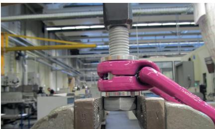
Abb. 8: Auflage des VLBG-PLUS zur Demontage der Schraube
