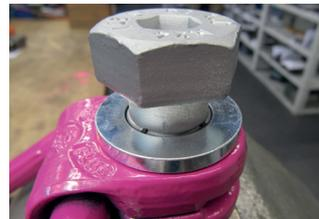
Abb. 10: Sprengling umlaufend vertieft in der Ansenkung positioniert
