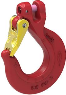
Geschmiedete, vergütete Sicherungsfalle in Hakenspitze einrastend, dadurch gegen seitliches Verbiegen geschützt. 3-fach gewickelte, rostgeschützte Doppelschenkelfeder. Verschleißkanten beidseitig. Markierung für Verschleiß der Maulweite und des Hakengrundes (Patent).
