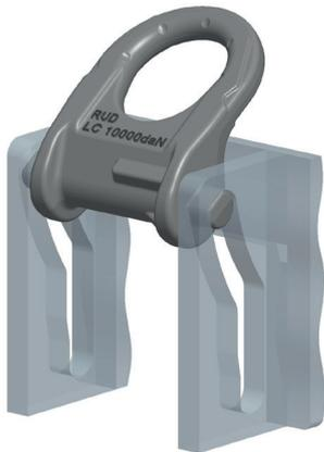
Abb. 3: Erlaubte Montage-Ausrichtung (RUD- und LC-Beschriftung zeigen entgegengesetzt zur Last)
