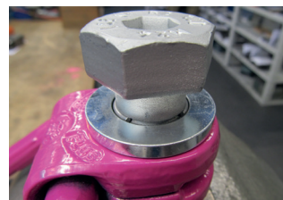
Abb. 7: Sprengring umlaufend vertieft in der Ansenkung positioniert
