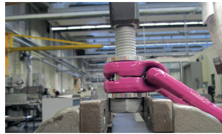
Abb. 5: Auflage des L-VLBG zur Demontage der Schraube
